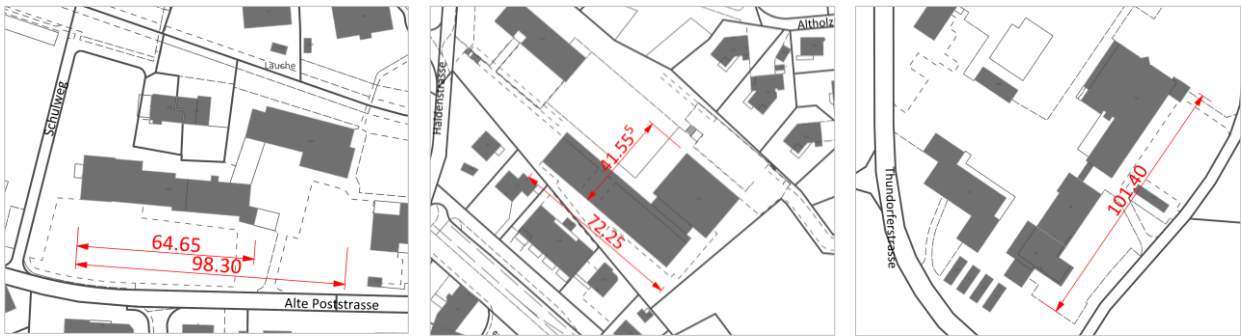
Überprüfung bestehender Gebäudelängen Schulhaus Mühli (links), Chatzenbuggel (mitte) und Buck (rechts)
